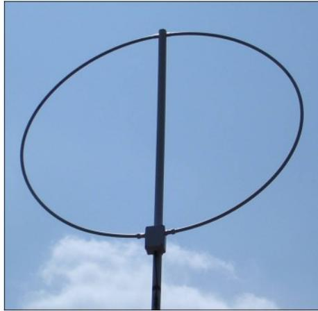
“Mini-Loop” è un’antenna destinata all’utilizzo da 100 KHz a 1.7MHz. Il loop è costituito da uno spezzone di 4 metri di RG-8 al quale ho interrotto la calza per 15mm esattamente a meta’ della sua lunghezza. Una volta asportata la guaina esterna e la calza, ho isolato il tutto con un pezzo di guaina termorestringente.
