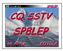
Ciò premesso, ecco i risultati. Un paio d'ore a 14230 kHz (tra le 10.16 e le 11.51 GMT di domenica 21), frequenza universalmente nota per l'SSTV (Slow Scan TeleVision), utilizzando la "Mini-whip" e il software "MMSTV" ha dato gli stessi risultati riscontrati, in condizioni propagative normali,
