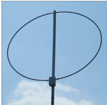
La "Coax-Loop" è un'antenna adatta all'utilizzo da 100 KHz a 1MHz. Il loop è costituito da uno spezzone di 4 metri di RG-8 al quale ho interrotto la calza per 15mm esattamente a metà della sua lunghezza. Una volta asportata la guaina esterna e la calza, ho isolato il tutto con un pezzo di guaina termorestringente.
